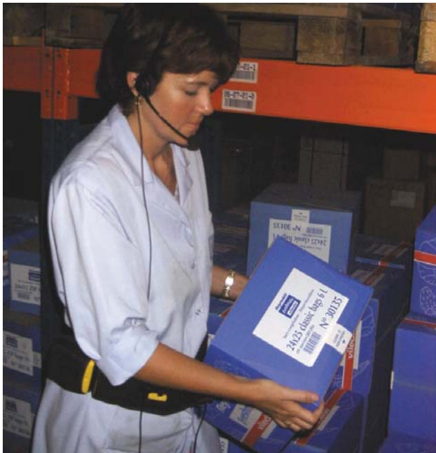
Bild 2 Beim Einsatz der Sprachverarbeitung im Wareneingang (Voice-to-Label) laufen Handling und Kommunikation parallel.
