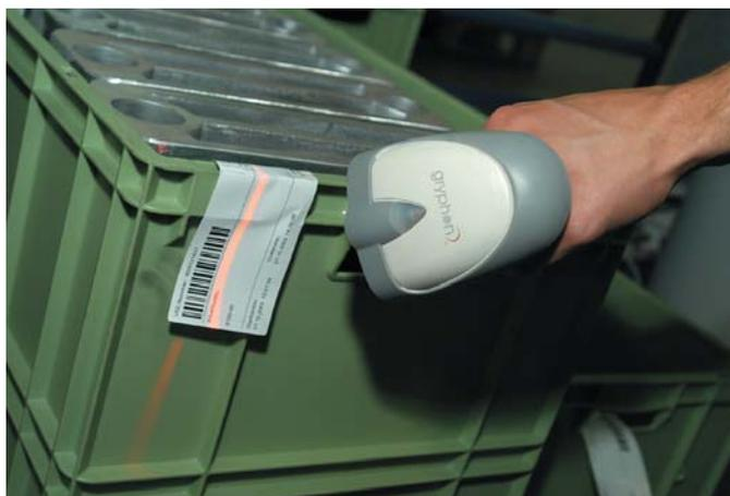
*Bild 3* Das einzulagernde Material wird mit einem Behälter verheiratet und mit einer HU-Nummer versehen – so findet das System den geeigneten Lagerplatz.
