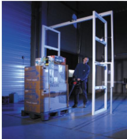
Bei der Fahrt durch das Gate-System mit integrierter Lesereinheit können über 100 verschiedene Artikel gleichzeitig gelesen werden.
