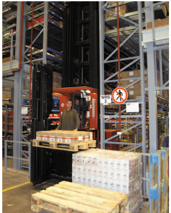
Bild 2 Schmalgangstapler CTX bei der Übernahme der bereitgestellten Palette. Bilder: BT Deutschland
