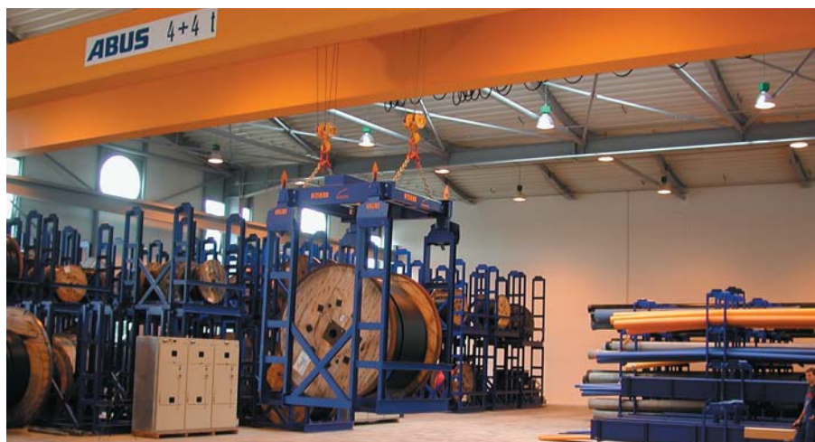
Bild 1 Rohre werden in Stapeljochen und Kabeltrommeln in Jochgestellen gelagert.
