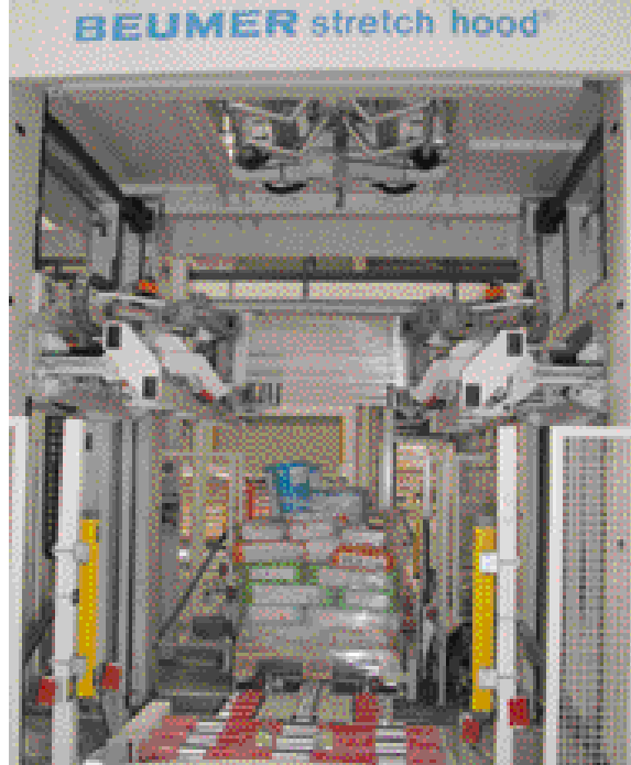
Bild 4 Über die Förderstrecken hinaus, sind auch die Verpackungsmaschinen, wie hier der Haubenstretcher, vollständig in SAP LES eingebunden.
