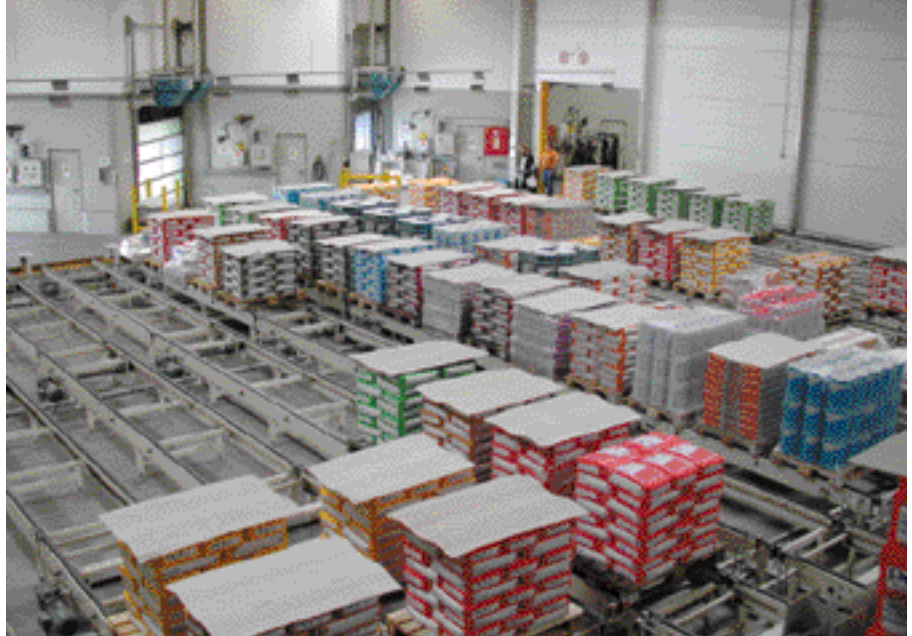
Bild 6 Blick in die Verladezone mit den Bereitstellbahnen – durch die Möglichkeit in LES mehrere Sendungen auf einer Palette zusammenzuführen, lassen sich die Förderstrecken um 20 bis 30 % besser auslasten.
