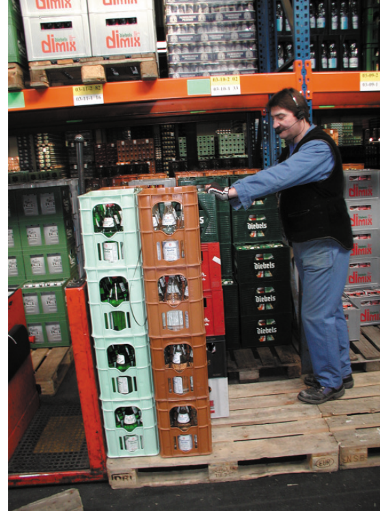
Bild 3 Durch die parallel zu Datenfunk eingesetzte Pick-by-Voice-Technologie konnten Pickfehler reduziert und Nachkontrollen ganz vermieden werden.
