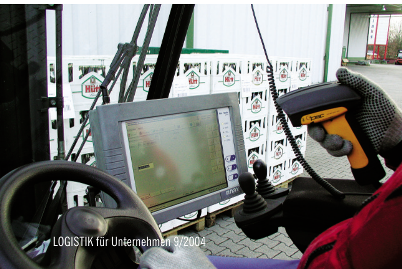
Bild 2 Der Touchscreen-Terminal wurde extra so konzipiert, dass er auch mit Handschuhen bedient werden kann.
