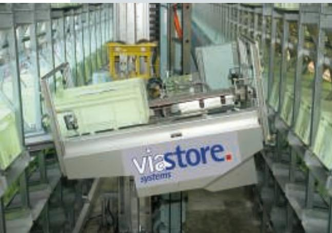
Das neue RBG „viaspeed“ mit Neigevorrichtung in der rückwärtigen Gasse.
