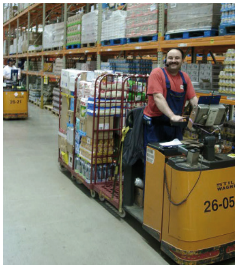
Bild 2 Das Lagerführungssystem leitet die Kommissionierer auf kürzestem Wege zu den Lagerplätzen und anschließend zu einer Konsolidierungsfläche, wo die verschiedenen Aufträge pro Filiale zusammengeführt werden.
