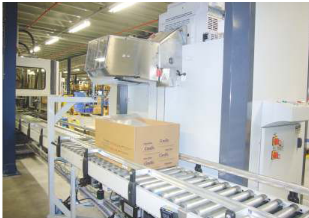
Bild 2 In alle Kartons mit empfindlichen Produkten werden vor dem Verschließen bedarfsgerecht gefüllte Luftkissen eingelegt.
