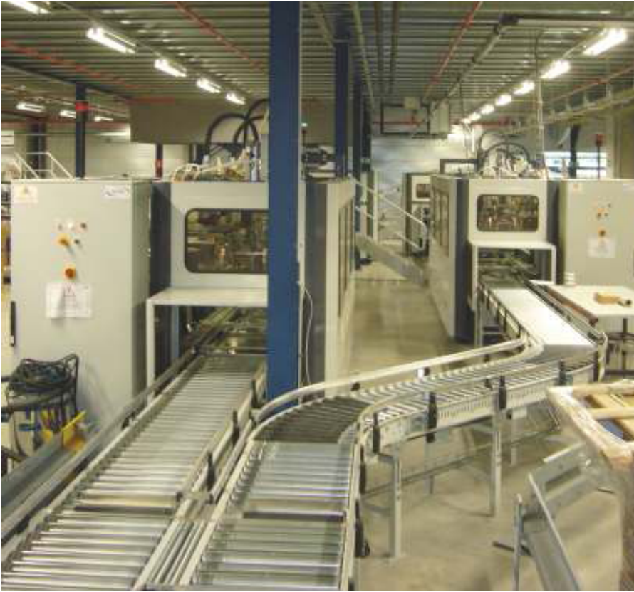
Bild 3 Auf der Verpackungsstrecke passen zwei Jivaro-Maschinen jeden Karton an die Füllhöhe an und verschließen ihn.
