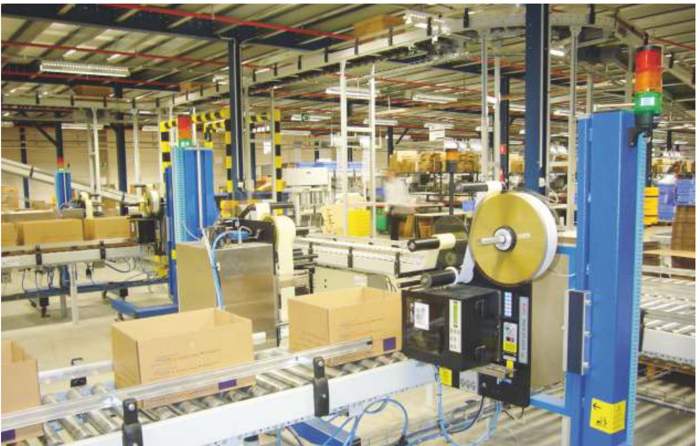
Bild 1 In der Warenannahme wird jeder Karton automatisch etikettiert und damit eindeutig gekennzeichnet.
