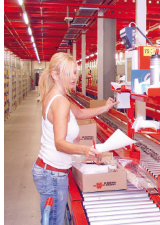
Bild 5 Blick in eine der vier Lager- und Kommissionierebenen im Distributionszentrum von Würth in s'Hertogenbosch – hier wird direkt in die Versandkartons kommissioniert. Bilder 4 und 5: Seemann
