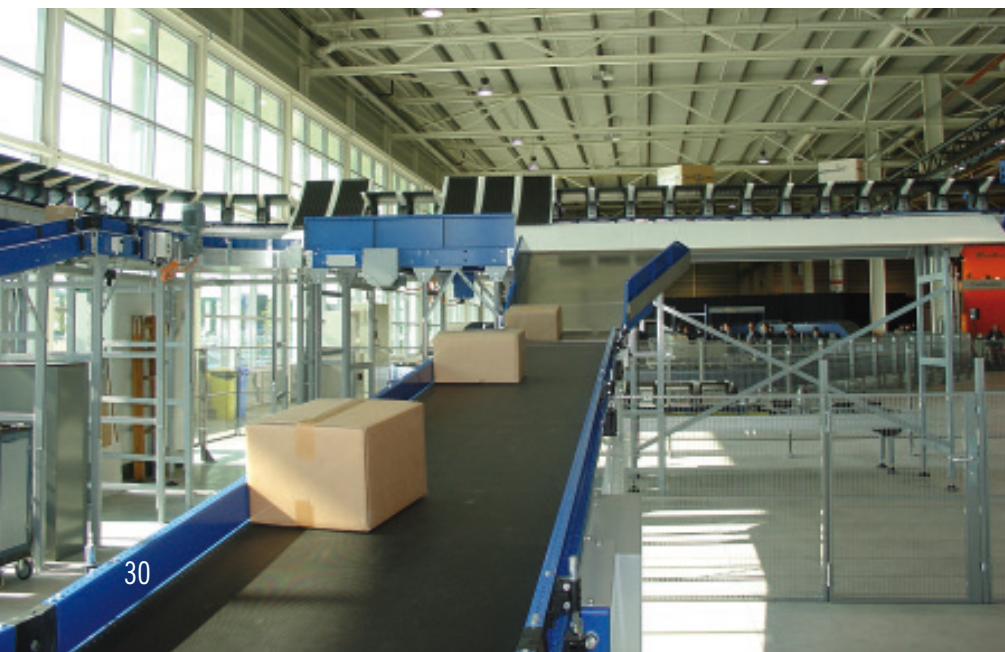
Bild 4 Durch die kleine Schalenteilung und die geschlossene Ausführung ist der neue Kippschalensorter „Expresorter“ besonders für die zuverlässige Sortierung vieler unterschiedlicher Artikel geeignet.
