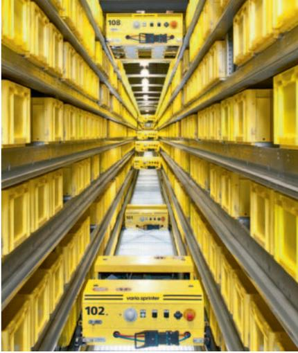
**Bei Shuttles und Regalbediengeräten bietet psb Energierückspeise-Module als Standard an.**
