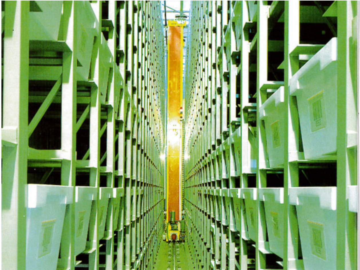
Die Regalbediengeräte fahren je nach Auslastungsgrad mit unterschiedlichen Geschwindigkeiten.
