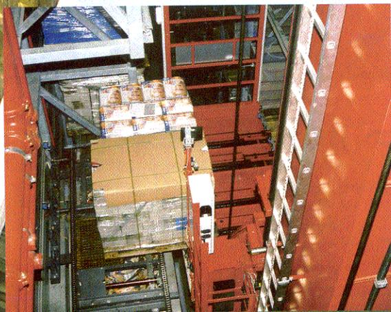
Die Lastaufnahmen der Regalbediengeräte vom Typ viapal sind mit zwei Teleskopgabeln ausgerüstet, über die zwei bis zu 1100 kg schwere Paletten separat aufgenommen werden können.
