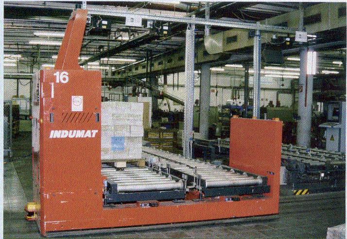
Von den Übergabebahnhöfen in der Produktion werden die Paletten mit den FTS-Fahrzeugen automatisch zum Hochregallager transportiert.
