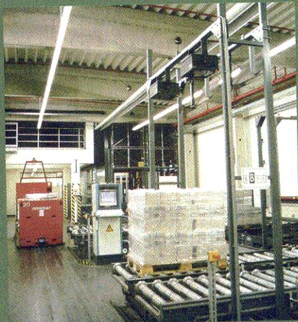
Bevor Paletten, die für den Versand bestimmt sind, eingelagert werden, durchlaufen sie eine automatische Verpackungsstraße.
