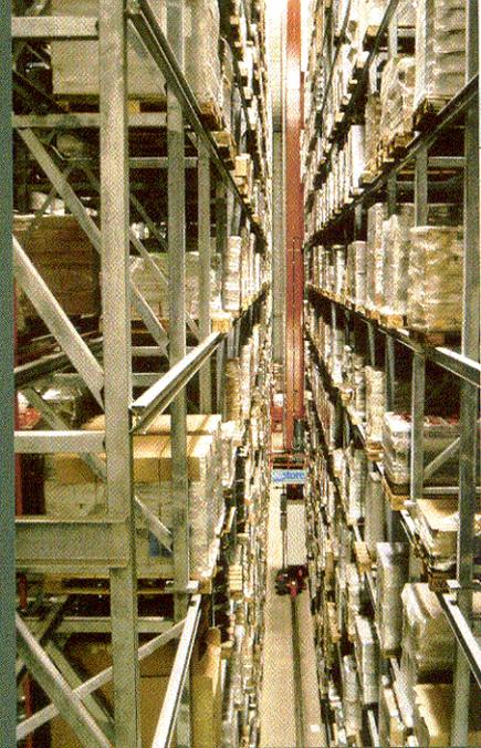
In acht Gassen werden auf einer Länge von 65 m und einer Höhe von 25 m rund 16 000 Paletten gelagert. Bilder: viastore
