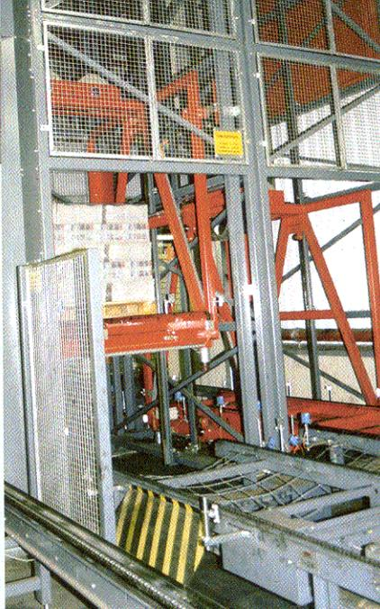
Eingelagert wird in der zweiten Etage des Hochregallagers, in die die Paletten über Aufzüge transportiert werden. Ausgelagert wird in der ersten Etage - nur so lassen sich die erforderlichen 200 Paletten pro Stunde einlagern.
