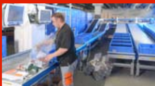
Innovativ Karussell-System SCS mit RFID-Behältern bei Lapp Kabel
