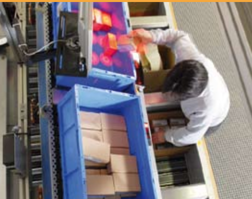
Mit bis zu 1.000 Ein- und Auslagerungen pro Stunde werden die Behälter an zwei "Pick to Tote"-Arbeitsplätzen zur Kommissionierung bereitgestellt.
