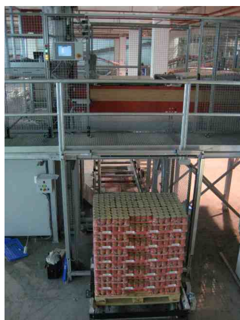
Zuführende Fördertechnik zum automatischen Depalettierer rechts: Depalettier-Vorgang
