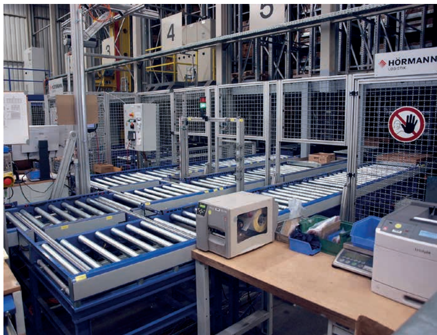
◀ (v.li.n.re.) Die Vorzone im Palettenlager Regalumbau Gasse 6 von der Fachboden-Regalanlage in ein Tablarregal Ein Kommissionierplatz im Tablarlager
