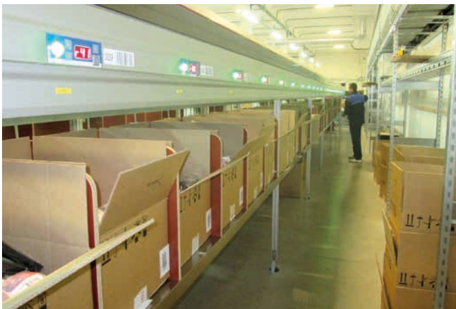
▲ Rund 30 000 Auftragspositionen bearbeiten die Kommissionierer im Logistikzentrum Minsk täglich. Durch intelligente IT und Automatisierung wurde der Tagesdurchsatz um mehr als 50 Prozent gesteigert
