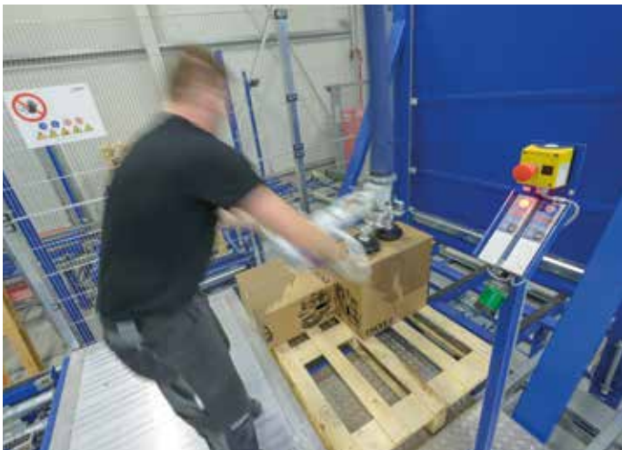
02 Mit Vakuumgreifern werden die Kartons angehoben
