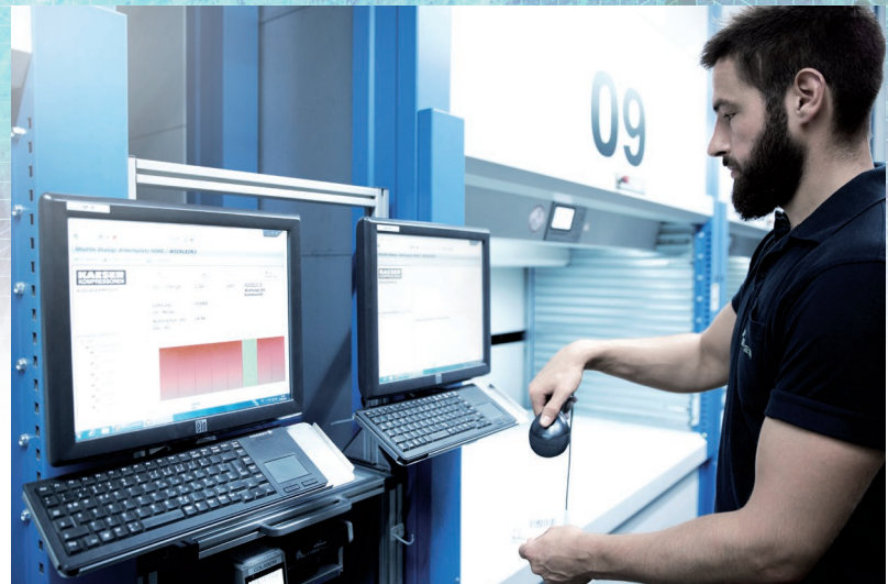
03 Auch die Steuerung der Umlaufregale ist jetzt in EWM integriert
