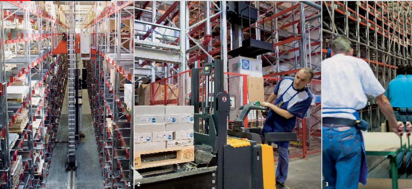
Moderne Technik sorgt im neuen Distributionszentrum von Maico für optimale Abläufe – ob nun im Bereich der Regalbediengeräte (1), beim Handling der Paletten im Wareneingang (2) oder bei der sprachgeführten Kommissionierung mittels Pick by Voice (3). Kluge Software gewährleistet, dass alles funktioniert.
