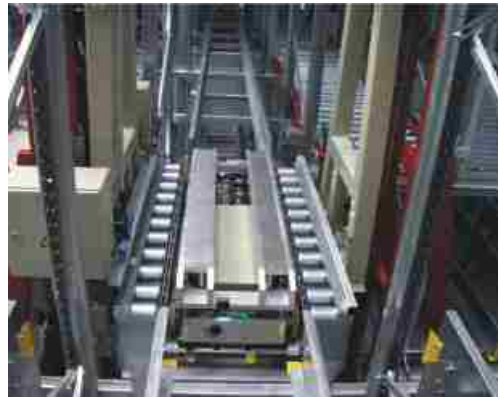
Neues AKF - Akku-Kanalfahrzeug - zur Längslagerung von Euro- bzw. Düsseldorfer Paletten.
