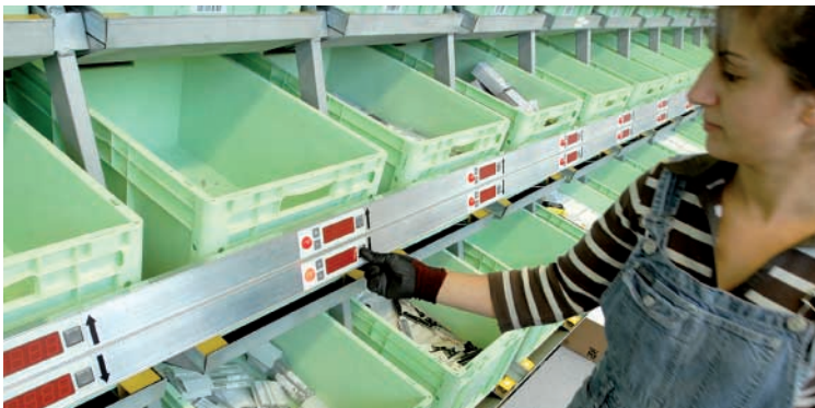
Die zu entnehmende Stückzahl wird der Kommissioniererin über „Pick-by-Light“ angezeigt.
