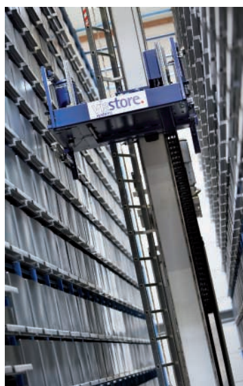
RBG vom Typ viaspeed mit Tablarverschiebeeinheit als Lastaufnahmemittel.
