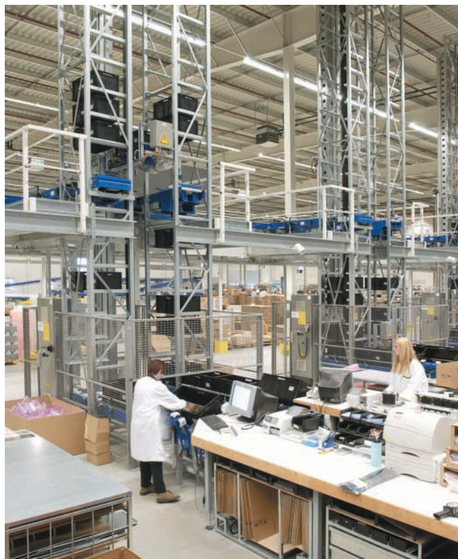
Bild links: Die Behälter werden vor der Kommissionierung in Turmspeichern gepuffert und auftragsrein sortiert. Bild rechts: Die Kommissionierarbeitsplätze sind nach ergonomischen Gesichtspunkten gestaltet – beispielsweise werden die Behälter gekippt, um das Greifen zu erleichtern.
