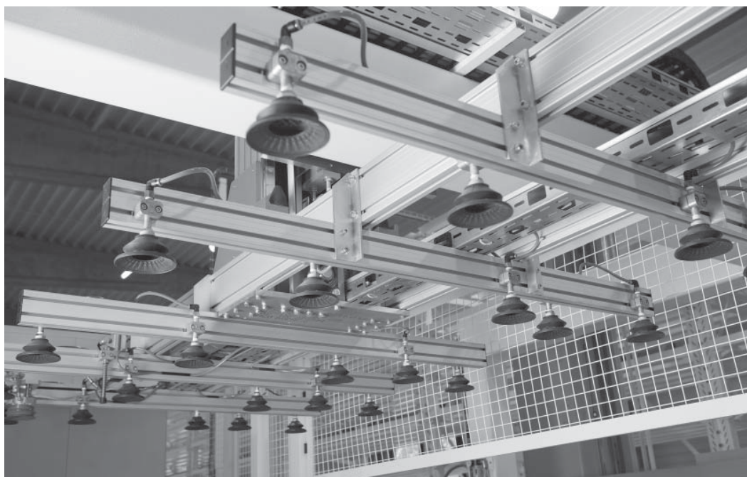
The vacuum gripper system can be used telescopically to both sides. Die Sauggreifer können beidseitig teleskopiert werden.
