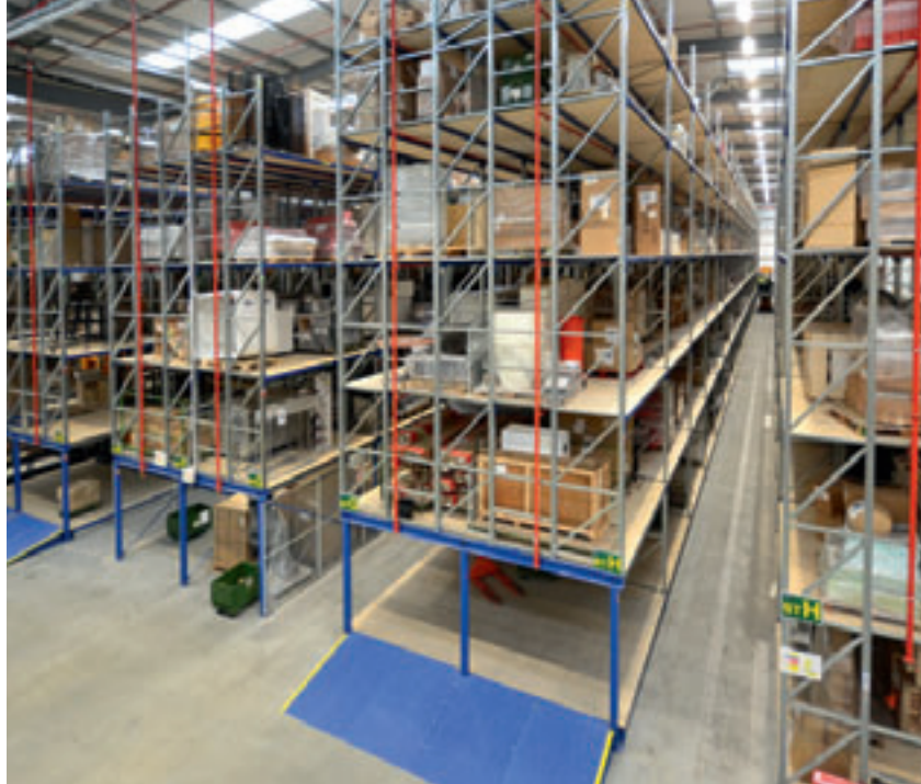
Das besondere Hochregal für große Artikel lässt sich durch ein spezielles Man-up-Fahrzeug bedienen
