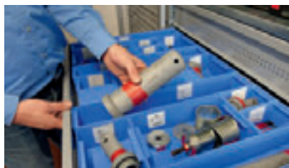
Mehr als 80 % der Werkzeuge liegen platzsparend in Modulkästen und Standardschubladen
