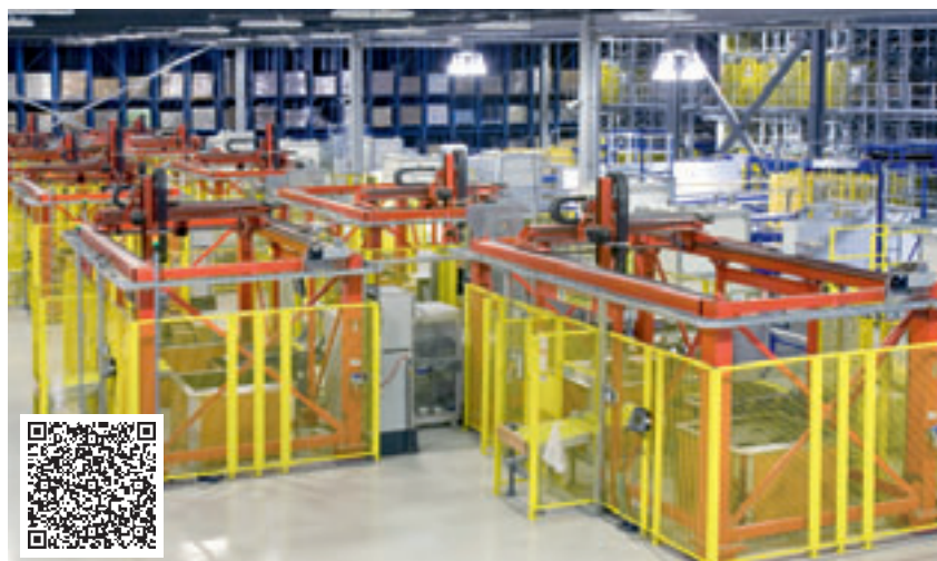
3 Förderbänder bedienen pro SCP-Modul 3 Palettierroboter, d. h. insgesamt 9 Palettierroboter konsolidieren die Kartons auftragsbezogen in der SCP-Anlage
