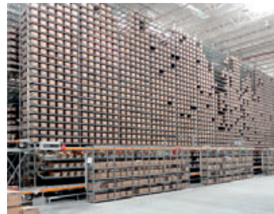
Das automatische Kleinteilelager sorgt für einen Durchsatz von bis zu 1.500 Aufträgen/Stunde
