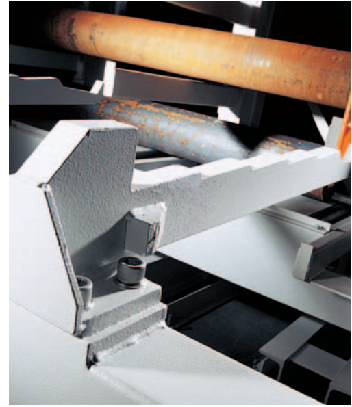
Die Anordnung der Gabelzinken oberhalb der Hubtraverse garantiert eine optimale Beladung durch den Kran oder Stapler.
