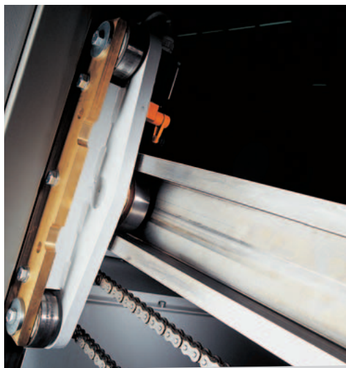
Präzise Lastaufnahme: Die Hubtraverse des KASTOlift ist mit rollengeführten Lastgabeln bestückt.
