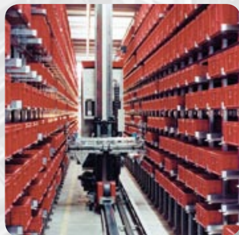
COGLAS® verwaltetes vollautomatisches Kleinteilelager
