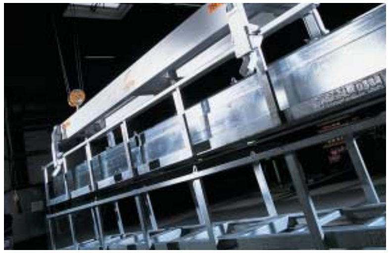
Universell : Mit der patentierten Greifertechnik können selbst kundenspezifische Transportbehälter wirtschaftlich transportiert und umgestapelt werden
