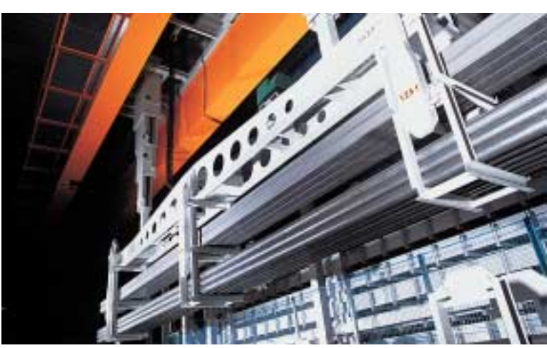
Schneller Transport: Mehrfachtransporttraverse mit 3 Aufnahmepearen und Teleskopführung beim Transport von 2 Lagerplätzen
