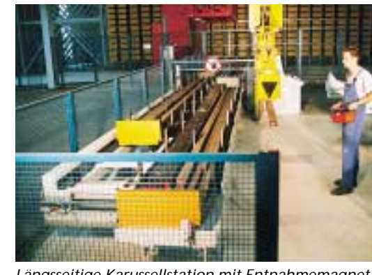
Längsseitige Karussellstation mit Entnahmemagnet
