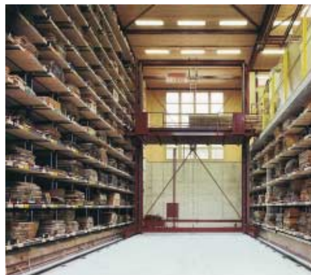
Halbautomatisches Wabenlager "Mann zur Ware"
