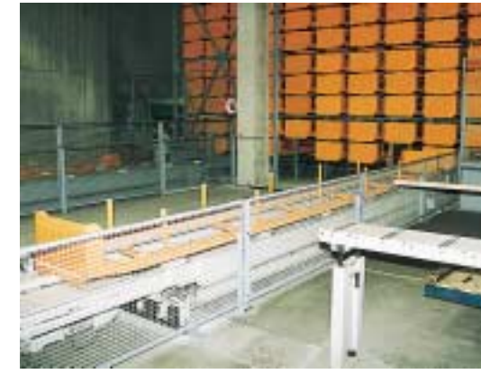
Querverfahrbarer Wagen mit Pufferstation
