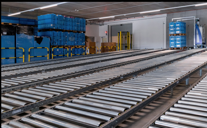
Ein- und Auslagerstation für Paletten im automatischen Hochregallager inklusive Drehtisch.
