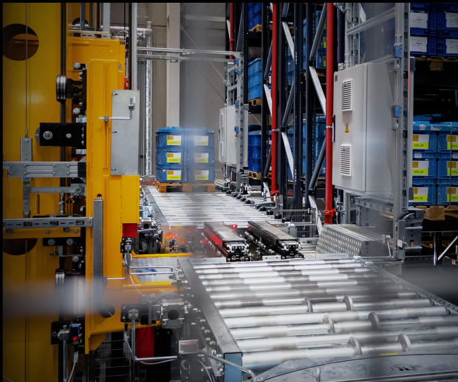
Ein- und Auslagerstation für Paletten im automatischen Hochregallager inklusive Drehtisch.
