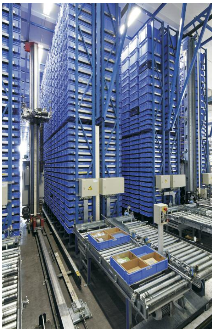
In den 14 000 Behälterstellplätzen des viergassigen ODU-AKLs werden rund 40 000 Artikel bevorratet
