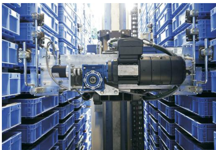
Die Lastaufnahmen wurden mit modifizierten Greiferpaaren und neuen Positionskontrollen ausgestattet
