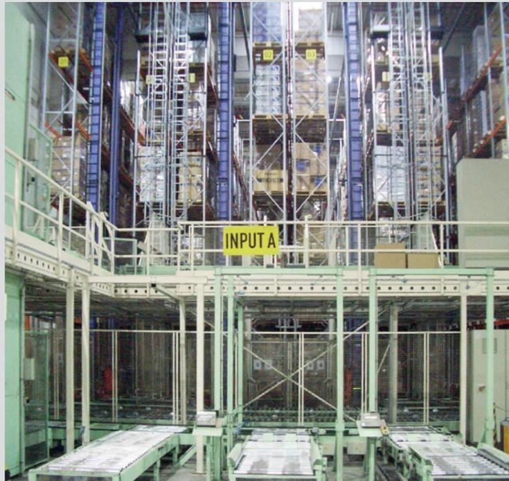
Das automatische Hochregallager von Nissin Hamburg umfasst 28 Gassen mit insgesamt 30.000 Palettenplätzen. Rund 40 Mitarbeiter stellen pro Tag etwa 1.000 Aufträge zusammen, das entspricht einem Volumen von 8.000 bis 10.000 Colli pro Tag.
