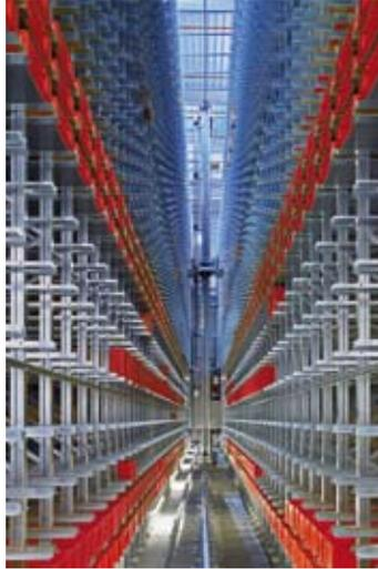
Mithilfe eines automatischen Fördersystems gelangen die Bauteile zu den ergonomischen Arbeitsplätzen, wo sie manuell verpackt werden. Die Fördertechnik verbindet den Wareneingang und die Produktprüfplätze mit dem Lager. Das ganze Equipment wird durch das Lagerverwaltungssystem von TGW gesteuert. ■
