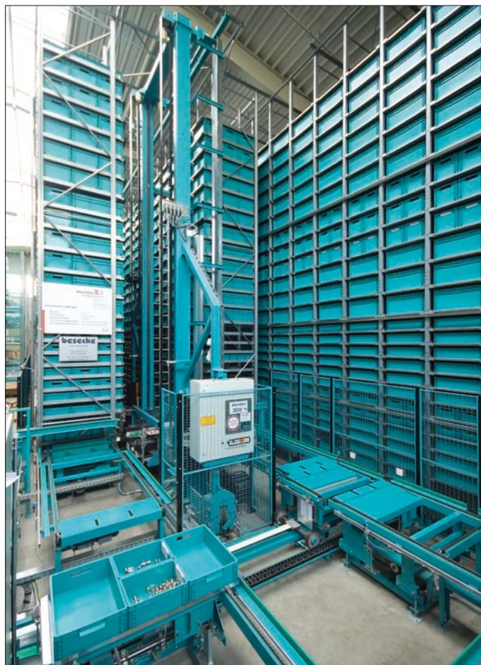
Auf den Tablaren (**Bild**) mit geschlossener und ebener Lauffläche (Abmessungen: 1306 × 616 × 34 mm) werden Behälter mit unterschiedlichen Höhen untergebracht, deren Gewicht bis zu 300 kg bei gleichmäßig verteilter Last betragen darf. Das zu befördernde Gut muss so sicher gepackt werden, dass es Beschleunigungen und Verzögerungen von 2 m/s<sup>2</sup> in allen Transportrichtungen unbeschadet und ohne Verschiebungen standhalten kann.
