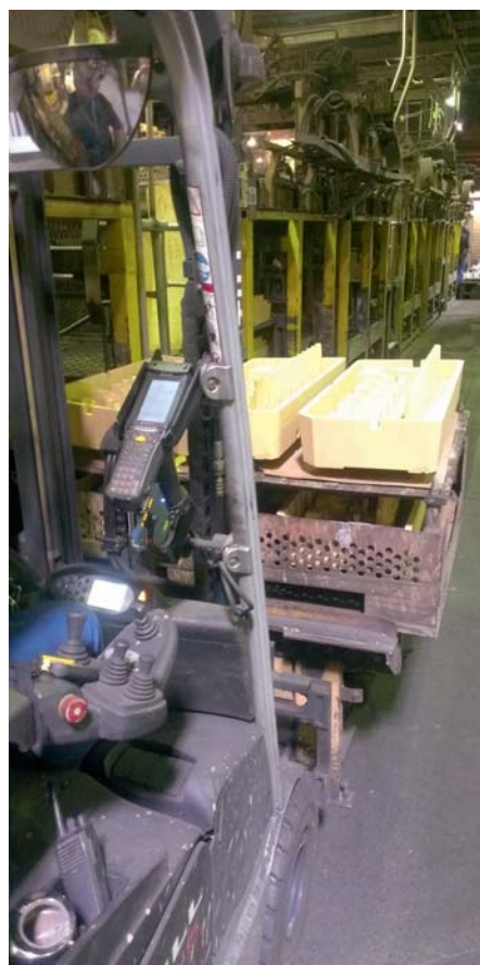
Stapler beim Abholen einer Palette mit Sandkernen; die vom PSlwms generierten Fahraufträge werden per Funk an das mobile Datenterminal übermittelt
