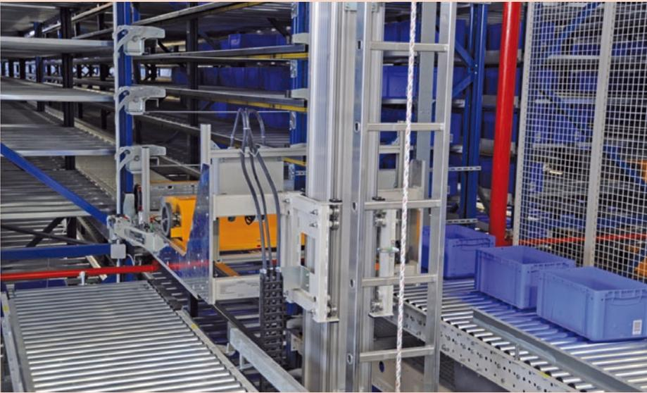
Bild 4: Über das Roaming-System wird der Transfer der Shuttle zwischen den einzelnen Regalebenen realisiert
