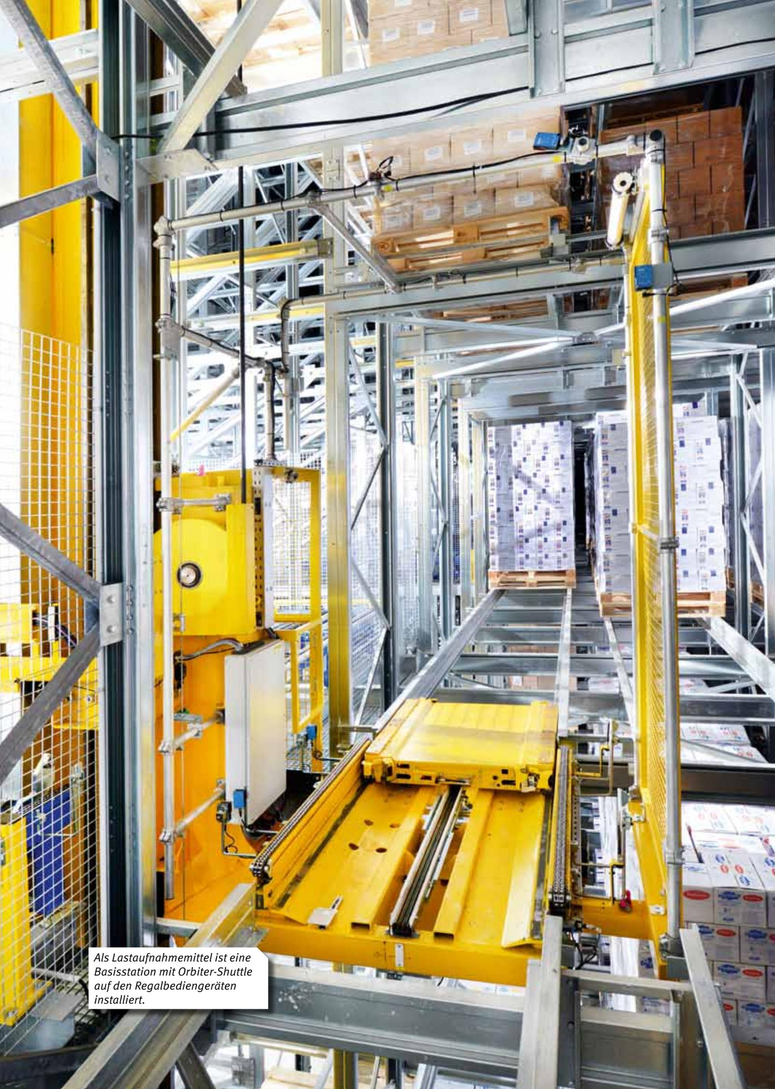
*Als Lastaufnahmemittel ist eine Basisstation mit Orbiter-Shuttle auf den Regalbediengeräten installiert.*
