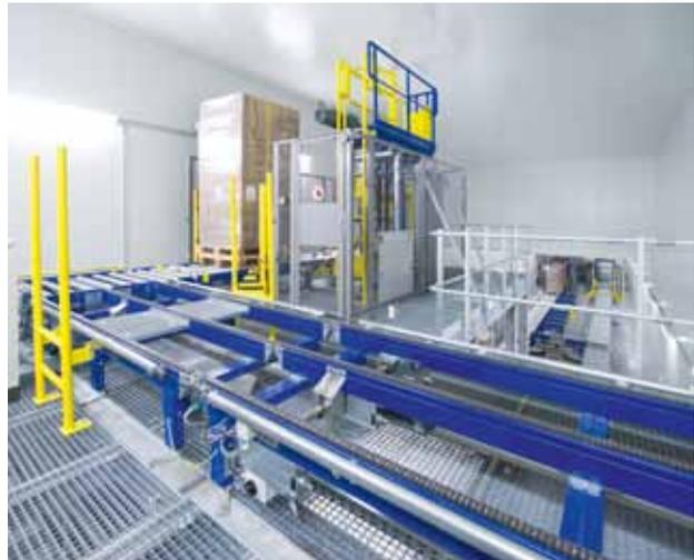
*Die zentrale Palettenfördertechnik bedient an den Einlagerstichen zwei Förderstrecken, die übereinander angebracht sind. Auf der unteren Ebene erfolgt die Einlagerung, über die obere Ebene die Auslagerung der Paletten aus dem HRL.*
