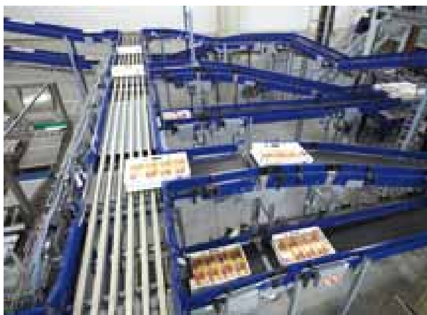
Rund 3000 Meter sind die Fördersysteme für die internen und externen Kistenkreisläufe des Werks lang.
