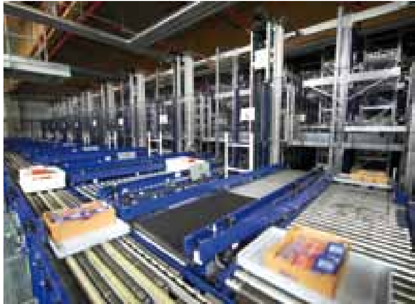
Auf beiden Seiten des HDS werden aktuell pro Stunde bis zu 3700 Kisten abgefördert.
