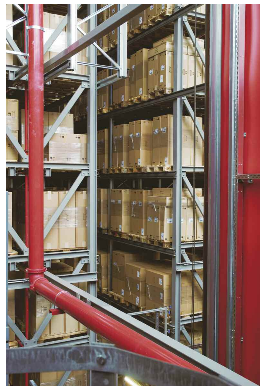
Im Hochregallager werden nur artikelreine Vollpaletten bevorratet, die unmittelbar aus der Produktion kommen
