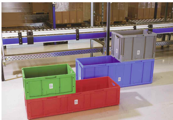
Um den vorhandenen Platz optimal zu nutzen, lagern die Produkte im AKL in vier verschiedenen Behältergrößen
