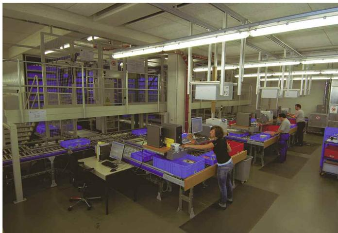
**Kommissionierzone in der Vorzone des Automatischen Kleinteilelagers bei Trumpf mit verschiedenfarbigen Behältern**
