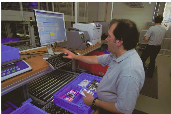
**Die Kommissionierer werden am Monitor sowie durch Lichtpositionsanzeigen auf die Behälterfächern unterstützt**
