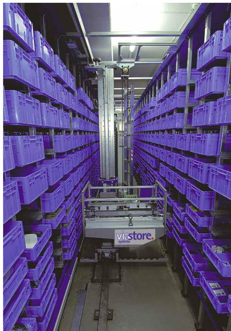
Das Kleinteilelager bei Trumpf dient als Lager und Sorter. Es wird von einem RBG des Typs Viaspeed versorgt
