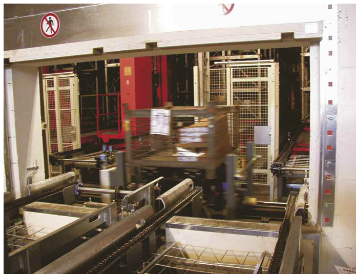
In der Vorzone des automatischen Lagers bei Iveco im Werk Donautal/Ulm: Übergabe an Verschiebewagen mit Teleskop
