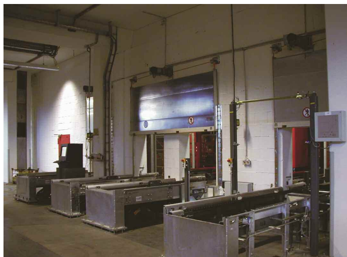
Vorzone des automatischen Hochregalpalettenlagers bei Iveco mit Übergabestationen zum Abholen durch Stapler
