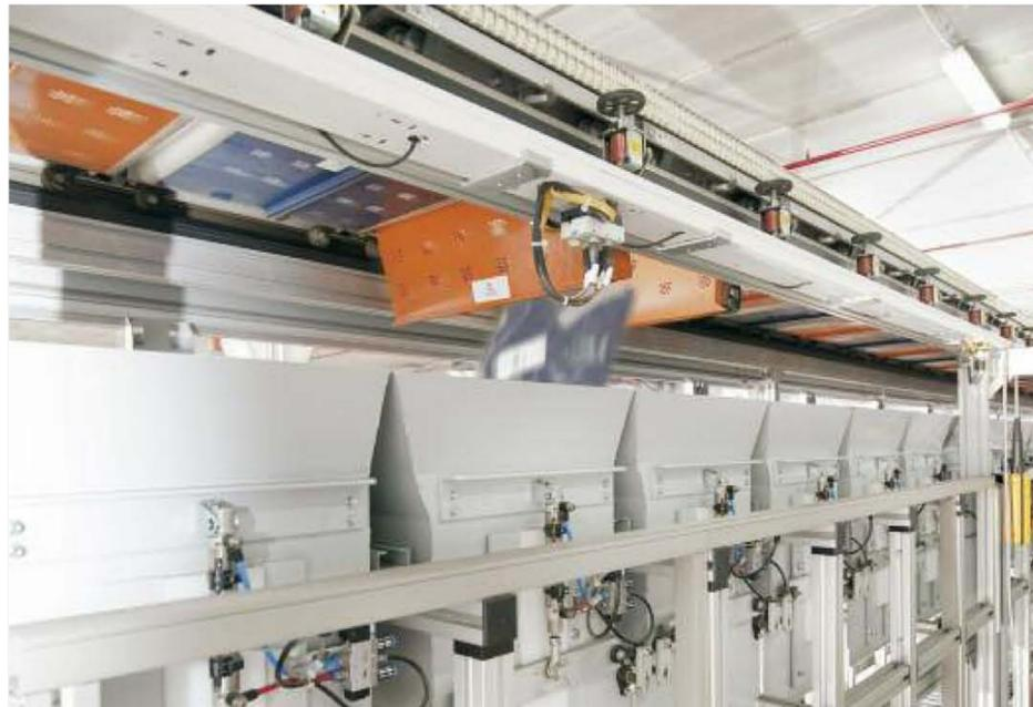
**Detail der Sortiertechnik in der Anlage von Salomon Automation bei Desigual: Sorterabwurf in einen Zwischenschacht**
