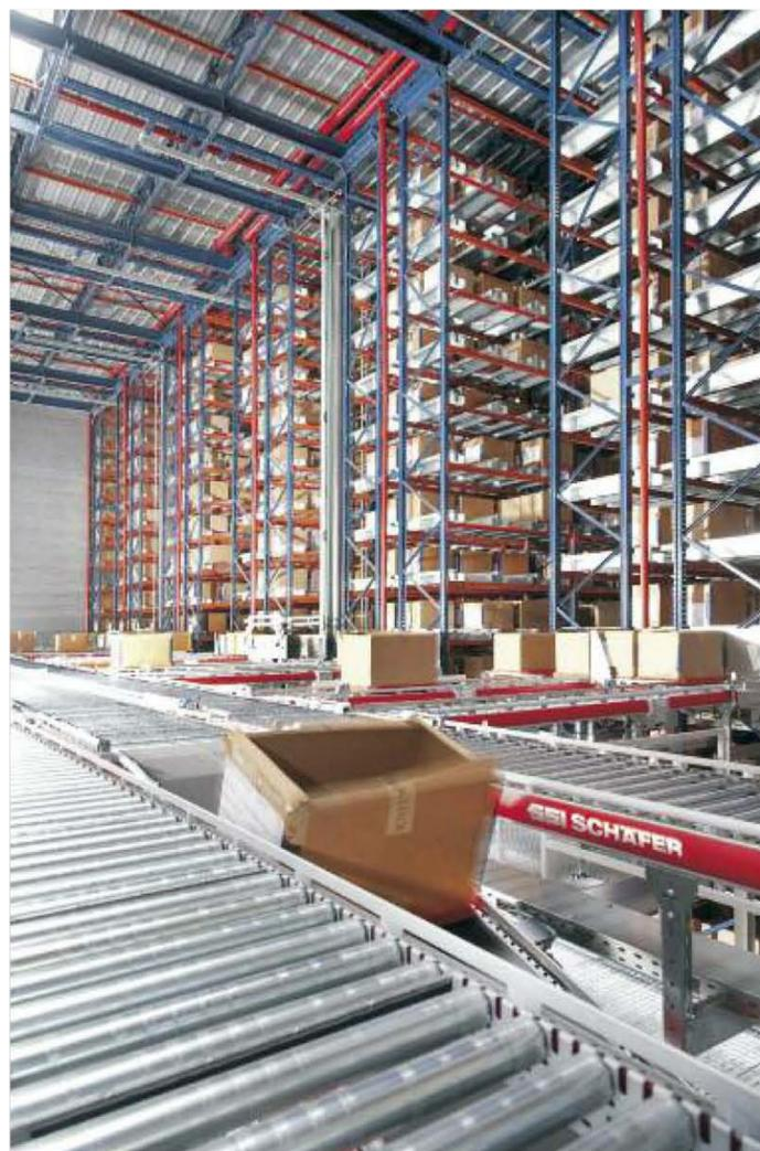
**Noch nicht fertig kommissionierte Kartons und Aufbruchkartons werden im AKL gepuffert**
