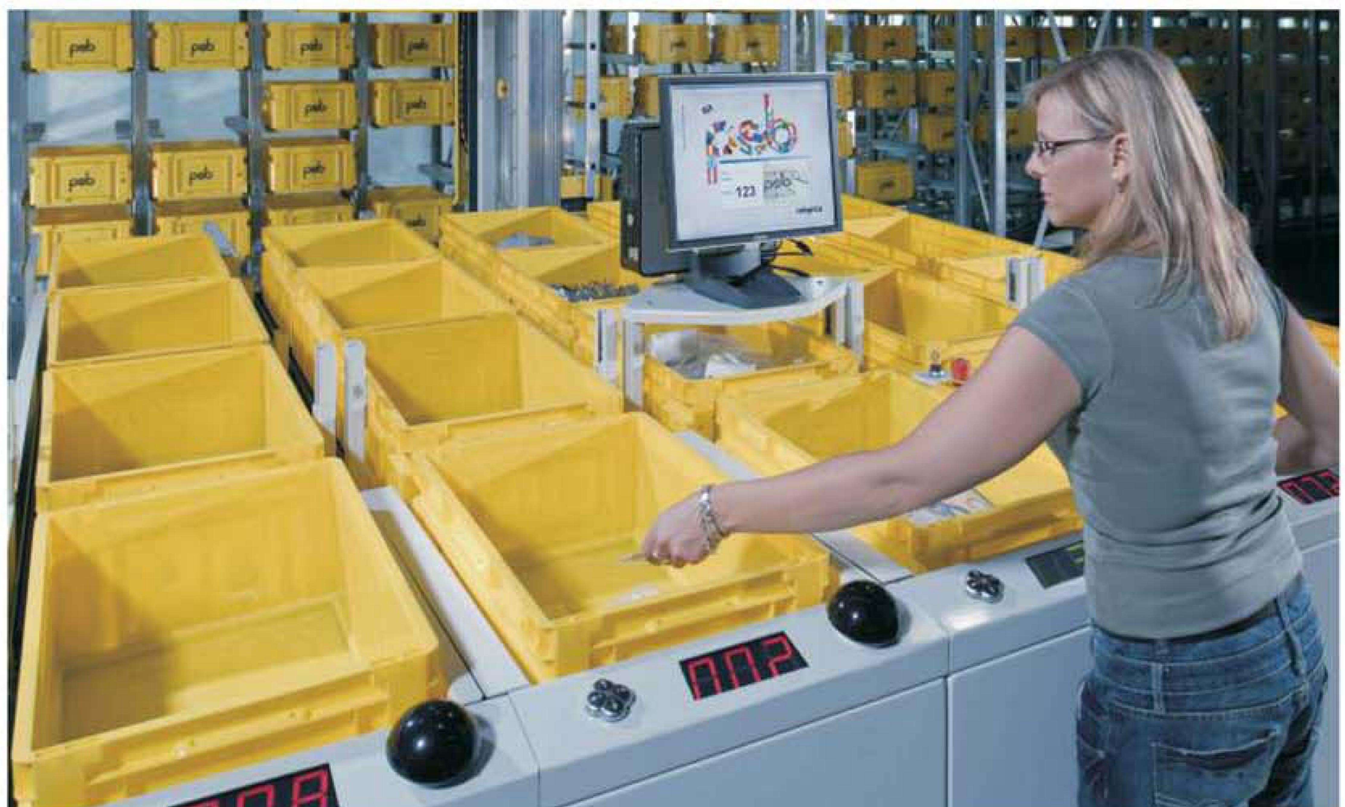
Mit dem ergonomischen Kommissioniersystem Rotapick lassen sich nach Angaben der PSB Intralogistik GmbH, Pirmasens, Leistungen bis über 1 000 Picks pro Stunde erzielen
