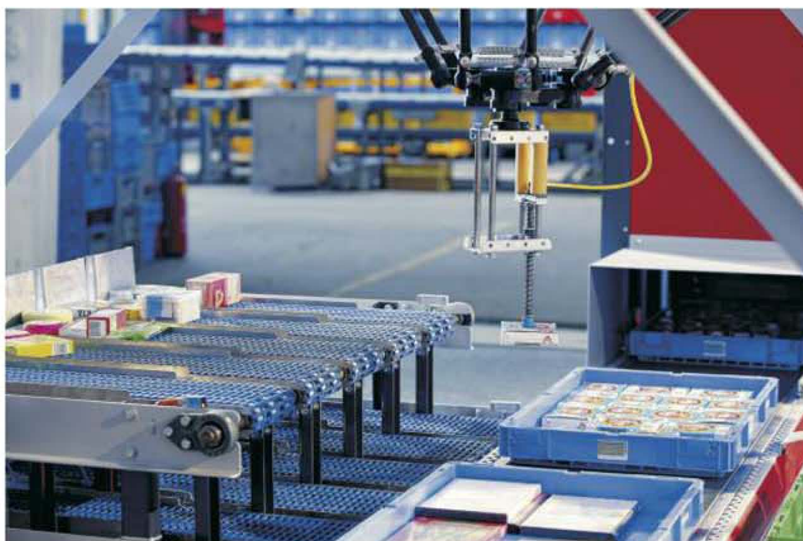
Mit Robo Pick verspricht SSI Schäfer einen technologischen Durchbruch in der Hochleistungskommissionierung – bis hinauf zu 2 000 Picks/h
