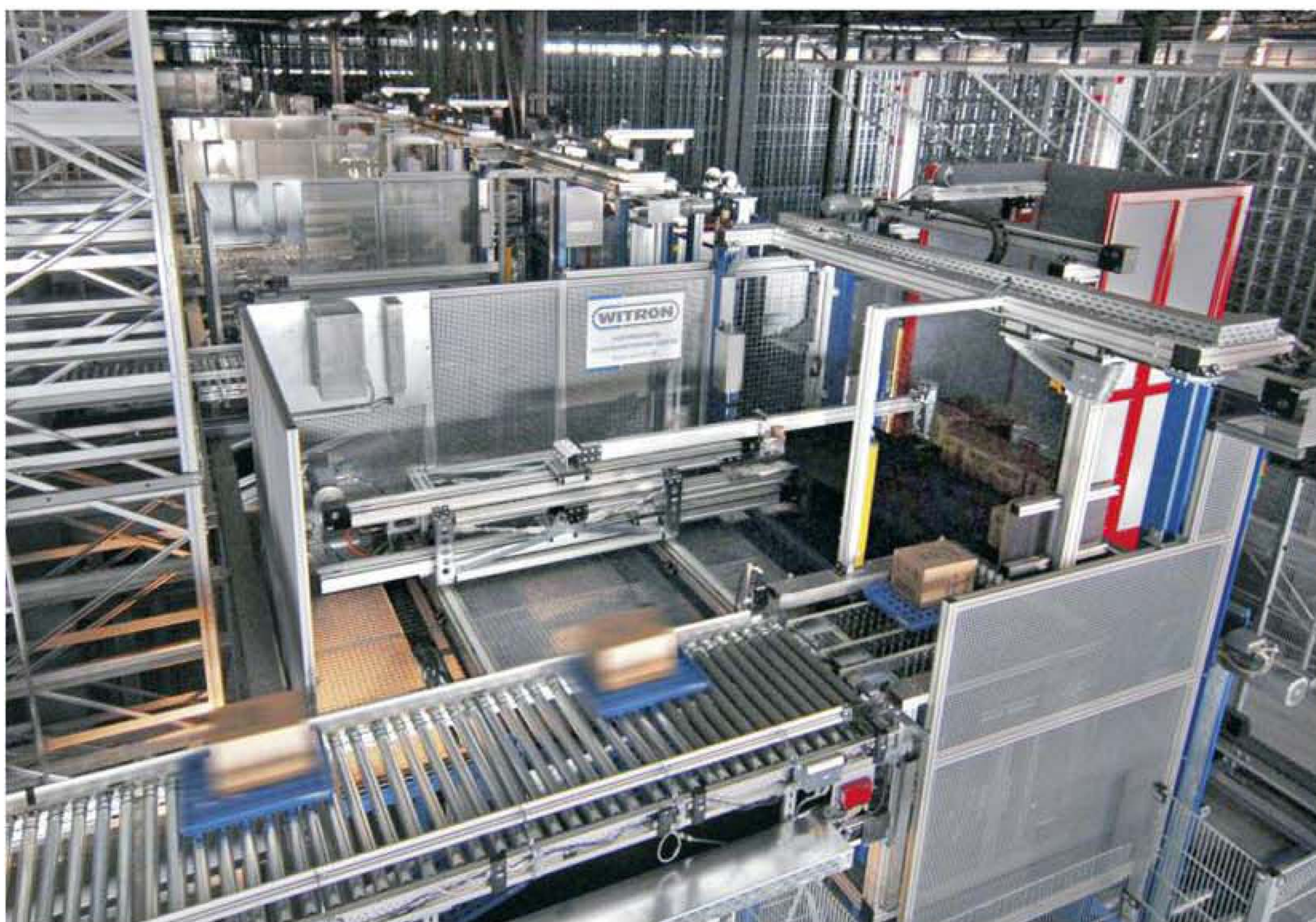
Mit dem OPM-System für die vollautomatische Kommissionierung im Lebensmitteleinzelhandel können sowohl Groß- als auch Kleinaufträge effizient und flexibel bearbeitet werden
