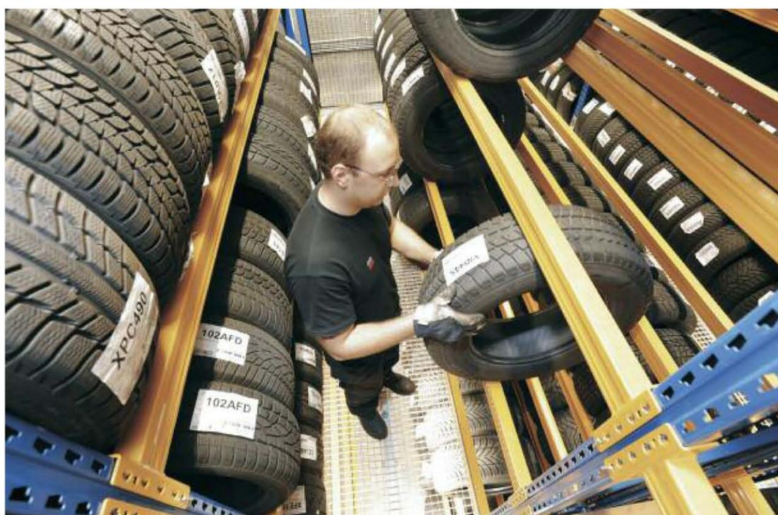
**Vor der Einlagerung wird jeder Reifen-Barcode gescannt. Vom Warehouse-Management-System wird ihm dann ein Lagerplatz zugewiesen**
