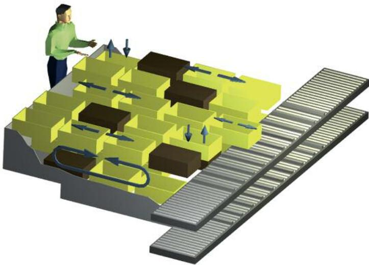
**Das modular aufgebaute System Rotapick von PSB Intralogistics basiert in seiner Kernfunktion darauf, möglichst viele Behälter oder Kartons auf engstem Raum und in unmittelbarem Zugriff bereitzustellen**
