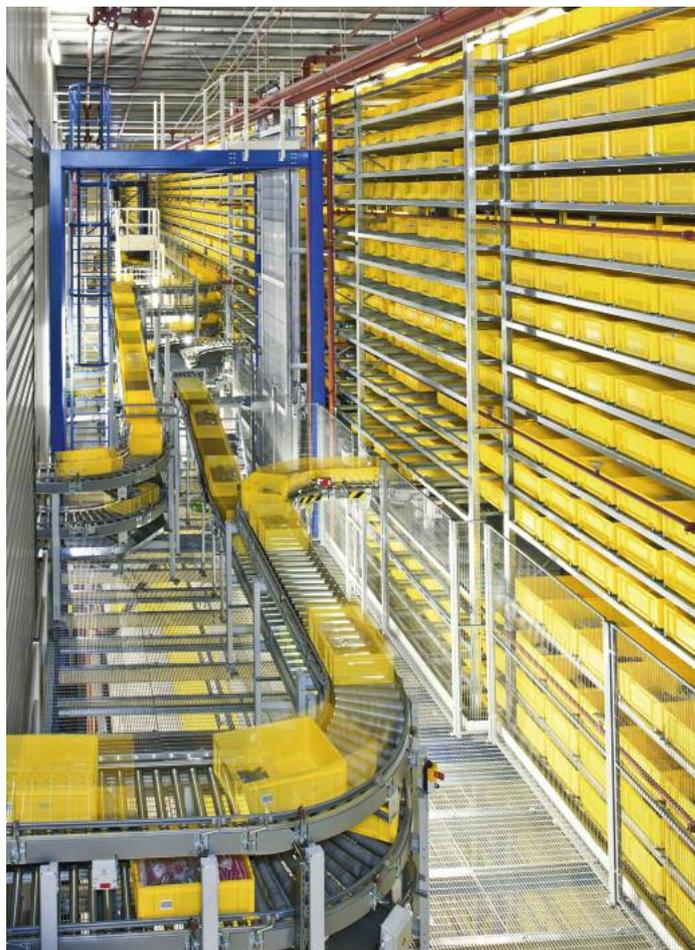
Die Zuführung der Behälter erfolgt kreuzungsfrei aus dem mit Vario-Sprinter-Shuttles organisierten Hochregallager
