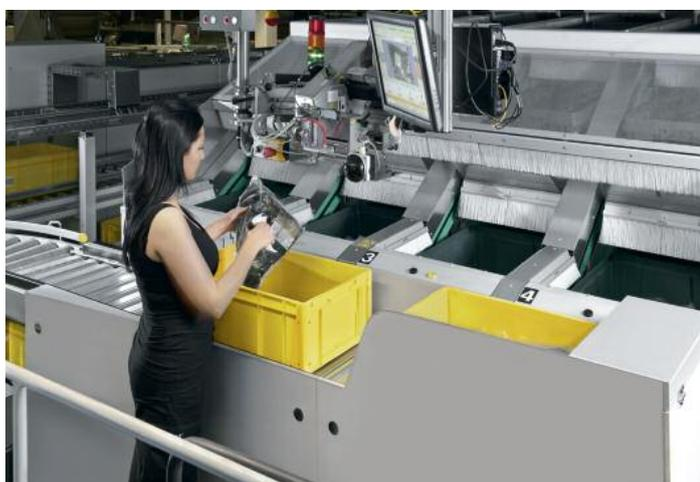
Am Rotapick werden die Artikel- und alle Auftragsbehälter, in die zukommissioniert wird, automatisch zur Verfügung gestellt
