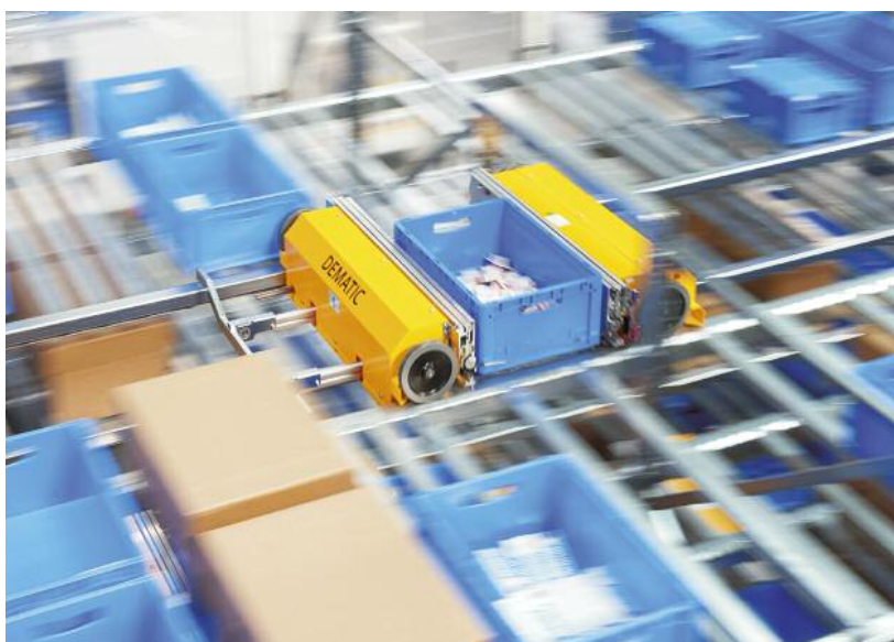
Mit dem neuen ‚Multishuttle Flex‘ können Behälter und Kartons unterschiedlicher Größe in einem einzigen System transportiert werden
