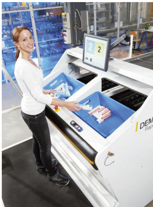
Neues Kommissioniersystem ‚Rapid Pick‘ als Teil einer automatischen Förderanlage
