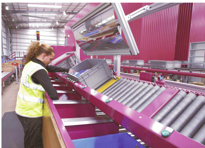
Kommissionierarbeitsplatz mit einem Pick-by-Light-System; die Picker haben beim Kommissionieren die Hände frei
