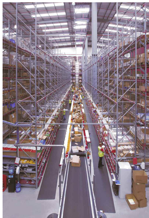
Kommissionierzone mit Pick-by-Light-Anlage (ASRS). Auf einer Grundfläche
