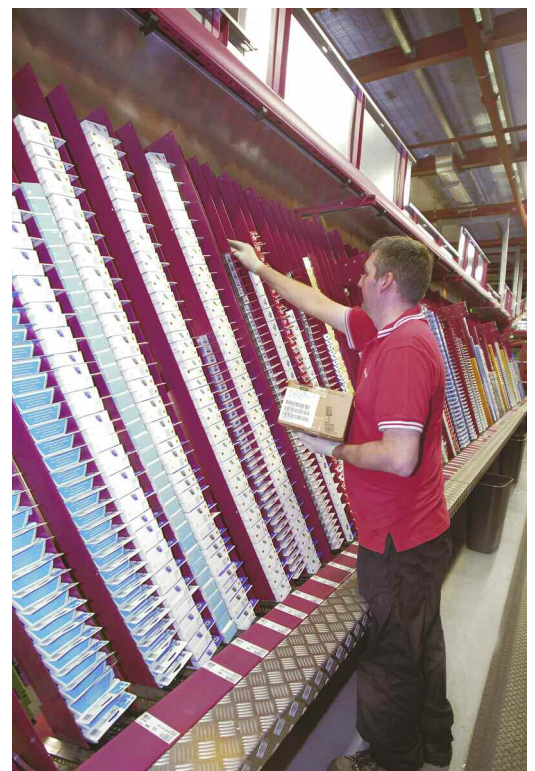
Kommissionierautomat S-Pemat zum Picken kleiner, schnell drehender Produkte
