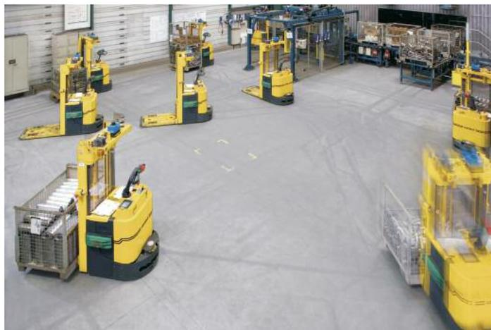
**Beim Automobilzulieferer Eberspächer verbindet ein fahrerloses Transportsystem von PSB verschiedene Produktionsbereiche**
