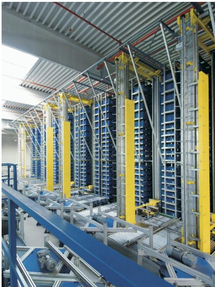
**Lagervorzone eines von PSB beim Logistikdienstleister CS Parts Logistics installierten automatischen Behälterlagers**
