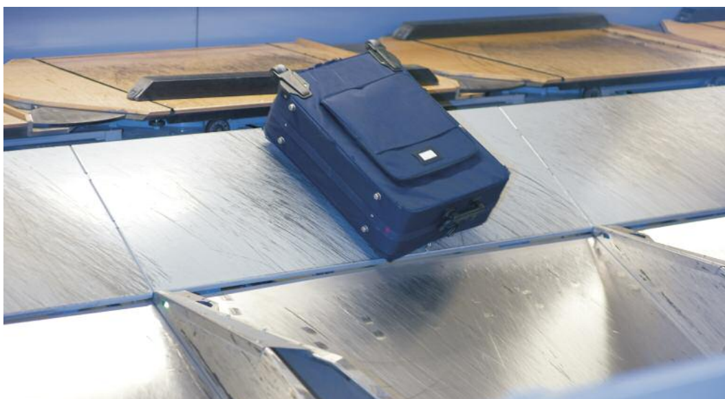
Vanderlande Industries wurde vom Edmonton International Airport mit der Lieferung eines Gepäckfördersystems beauftragt. Das Foto zeigt das energiesparende Sortiersystem Baxorter
